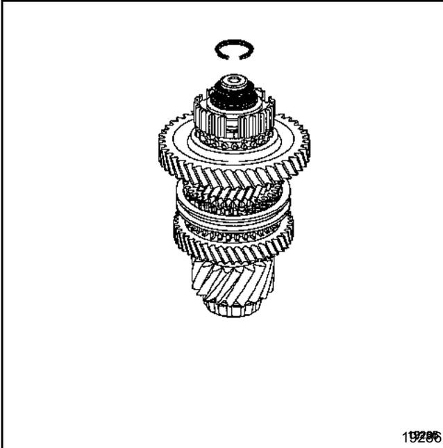
Déposer à la presse l'ensemble bagues pignons moyeux en prenant appui sous le pignon de 3<sup>ème</sup> à l'aide de l'outil **B. Vi. 1510 indice L**.
