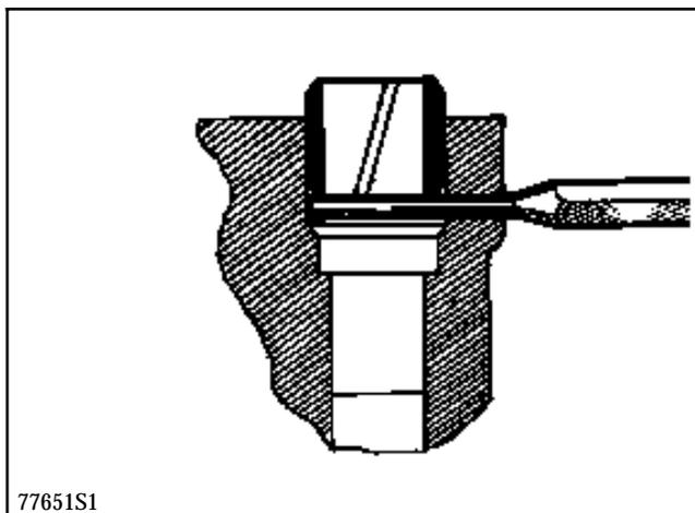
Procéder au nettoyage du plan de joint de la culasse et du carter-cylindres. Utiliser le produit **Décapjoint**.
