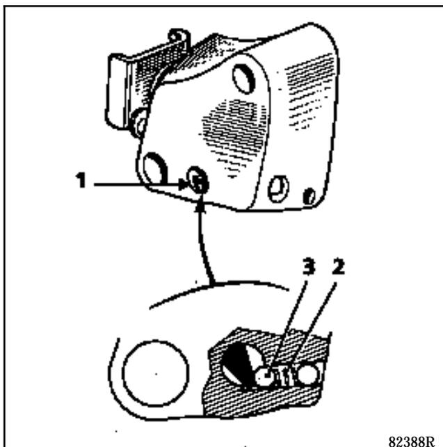
Désarmer les deux tendeurs de chaîne en tournant les cliquets avec un tournevis dans le sens inverse des aiguilles d'une montre
