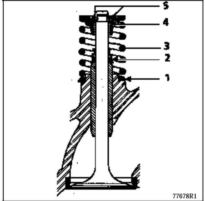
Comprimer les ressorts avec un compresseur (Ex. FACOM U 43 LA) placer les demi-bagues sur la queue de soupape.
