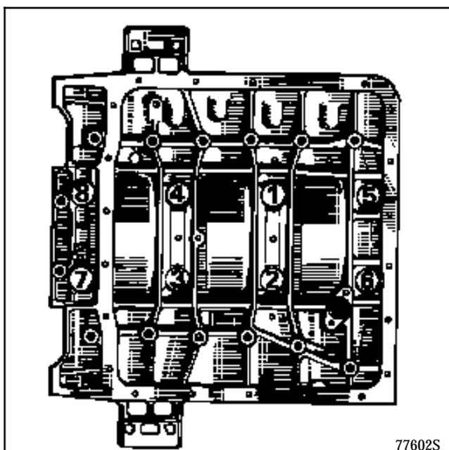
Effectuer le repérage des bielles en commençant côté volant moteur de façon à ce que leur numérotation soit identique à celui des cylindres.
