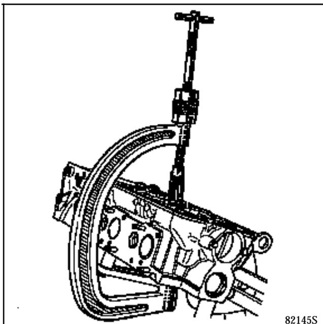
La dépose des joints de queue de soupapes s'effectue avec une pince (Ex. FACOM DM 10 A)
