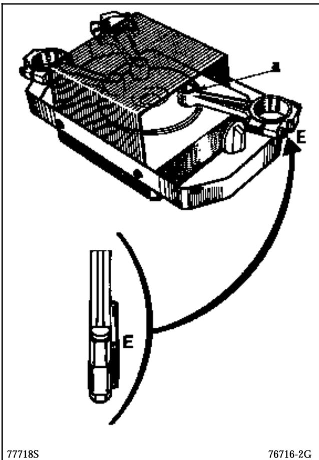
Chauffer le pied de bielle jusqu'à fusion du témoin de soudure autodécapante
