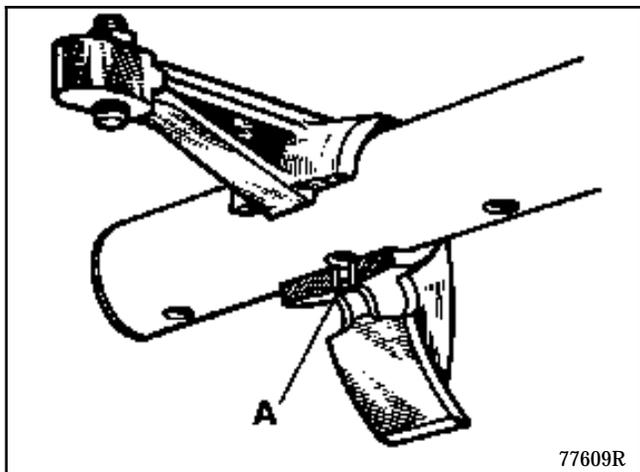
**ATTENTION :** les ajutages (A) des culbuteurs et de la rampe doivent être débouchés et propres (risque de détérioration de l'arbre à cames).
