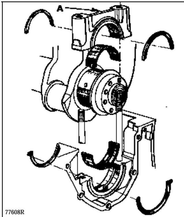
Placer un comparateur en bout de vilebrequin et l'étalonner sur zéro, vilebrequin en butée côté embrayage.
