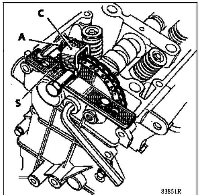
Afin de ne pas décaler la distribution, utiliser le faux palier (F) uniquement dans le cas où il sera nécessaire de faire tourner le vilebrequin, par exemple : remplacement des ensembles "chemise-piston".
