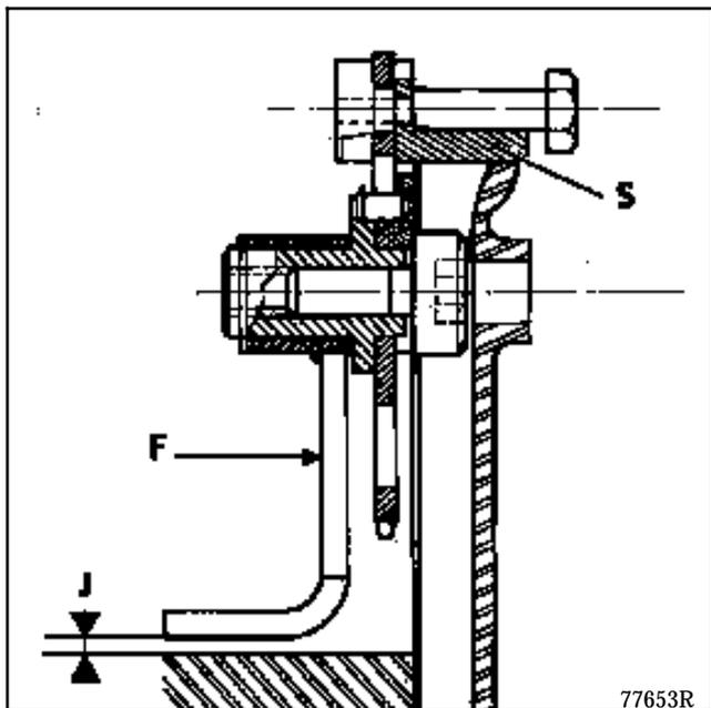
Dans le cas où un jeu (J) apparaît entre la semelle du faux palier et le plan de joint du carter-cylindres, interposer des cales de clinquant afin d'éviter toute détente de la chaîne de distribution risquant de bloquer le tendeur en position avancée.
