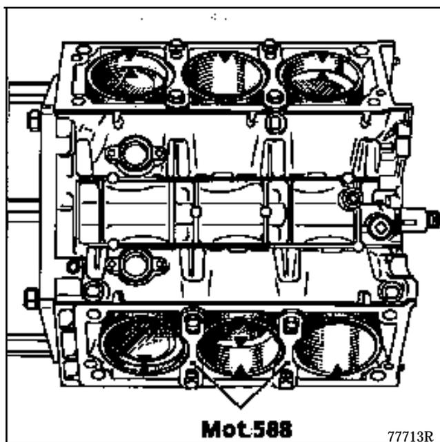
Evacuer à l'aide d'une seringue le liquide de refroidissement restant dans le bloc-cylindres.
