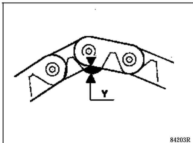
Dans le cas où le remplacement s'avère nécessaire, il est impératif de remplacer toutes les pièces formant la distribution : chaînes, pignons, patins et tendeurs.
