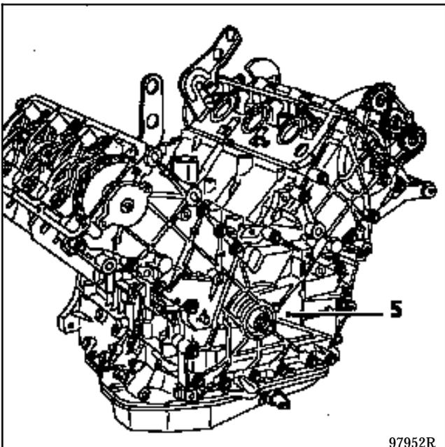
**NOTA :** Pour les moteurs avec le distributeur d'allumeur côté carter de distribution, retirer le doigt d'allumeur, déposer la vis (6) puis le carter de distribution (5)
