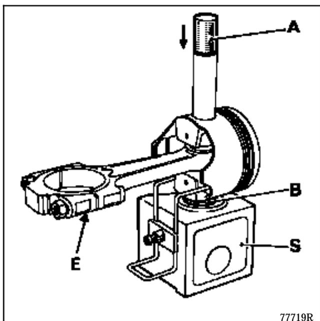
Après quelques secondes, déposer l'ensemble bielle-piston du socle support, dévisser le centreur et retirer l'axe.
