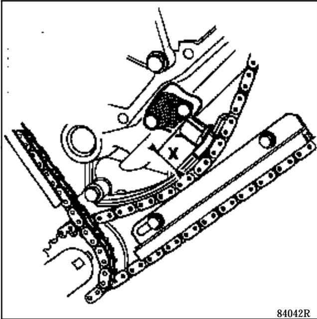
D'autre part, en s'éclairant correctement, il est possible d'évaluer la longueur (X) de sortie du piston de tendeur de chaîne.
