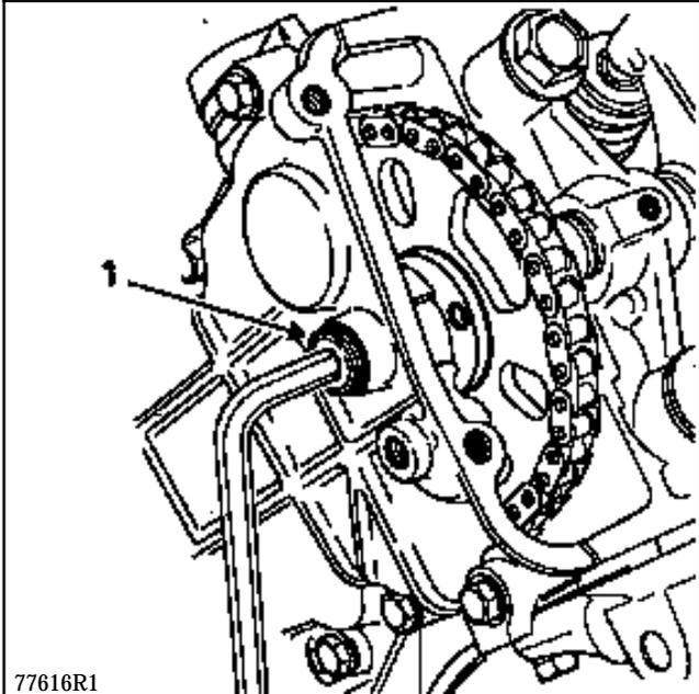
Extraire le joint d'étanchéité de palier d'arbre à cames.
