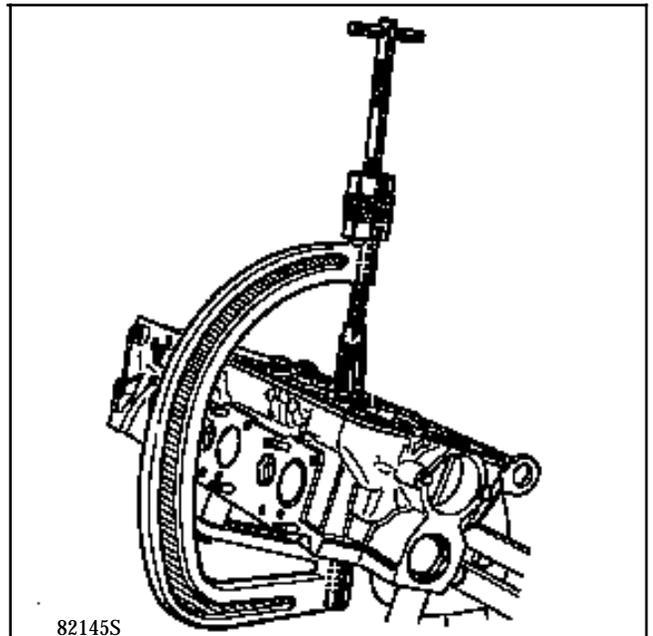
Reposer l'arbre à cames dans la culasse et positionner la bride (8) et répartir le jeu de la bride de part et d'autre de l'arbre à cames.
