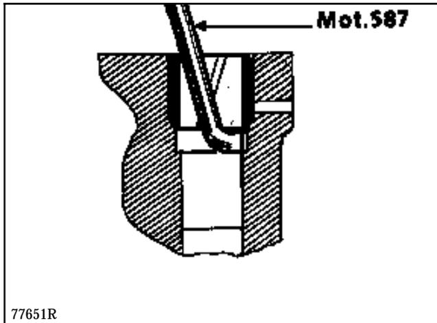
Mettre les douilles à hauteur correcte en utilisant un chasse goupille  $\varnothing 3$  mm.
