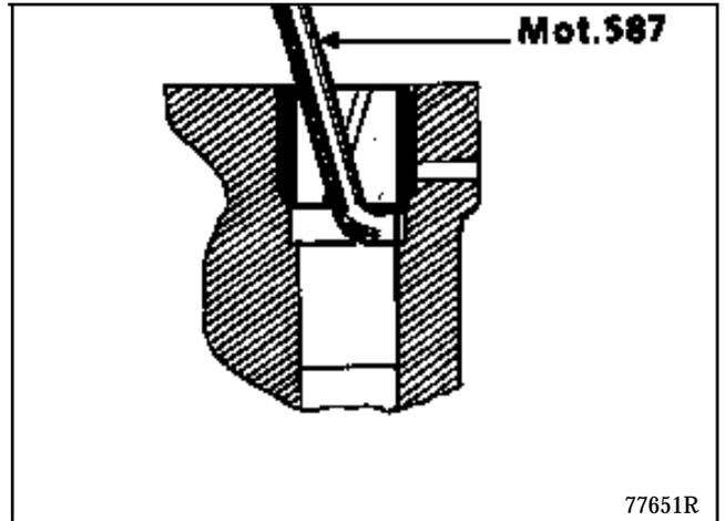
Mettre les douilles à hauteur correcte en utilisant un chasse goupilles Ø 3 mm.
