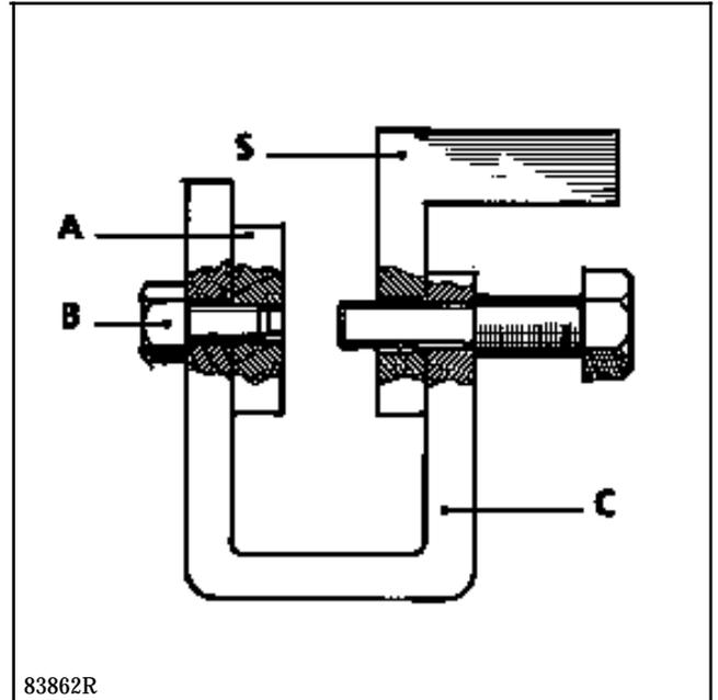
La pièce (A) est fixée à l'intérieur du cavalier (C) au moyen de la vis (B) (M7x100 ; longueur sous tête : 12 mm).
