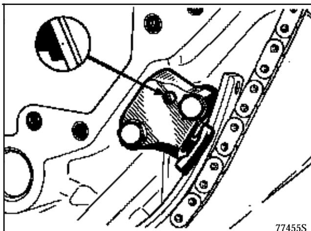
Le contrôle du calage de la distribution s'effectue à partir de la position de montage de la chaîne du groupe B.
