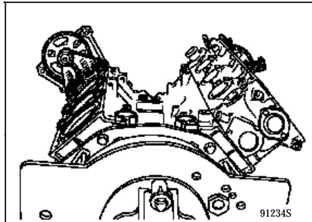
Dépose des deux culasses
