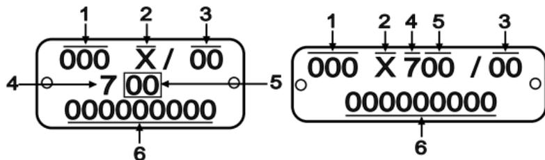
Plaque rivée sur le carter cylindres de forme définie par l'encombrement disponible sur le moteur.
