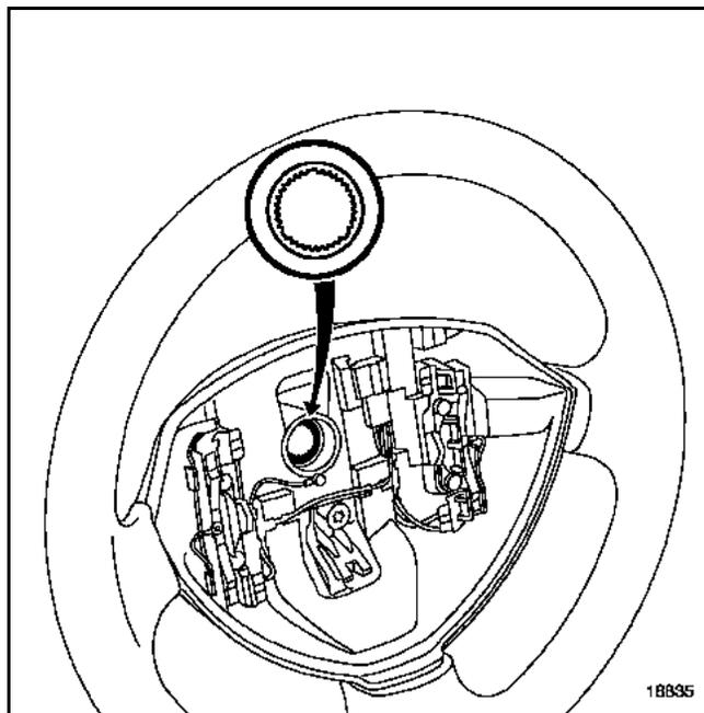
**ATTENTION** : les cannelures du volant possèdent des détrompeurs. Le volant doit rentrer librement dans les cannelures.
