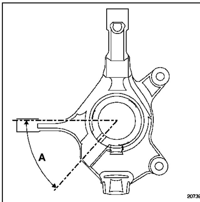
Reposer le roulement dans le porte-fusée à l'aide des outils D, E et F. La cible noire **ABS** orientée côté intérieur du porte-fusée.
