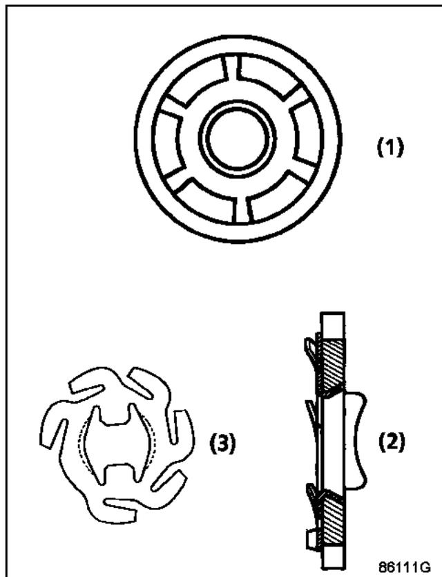
Avant le serrage définitif de la rotule axiale à l'aide de l'outil **Dir. 1305-01**, vérifier que les languettes de la rondelle arrêt (2) coïncident bien avec les méplats (A) de la crémaillère.
