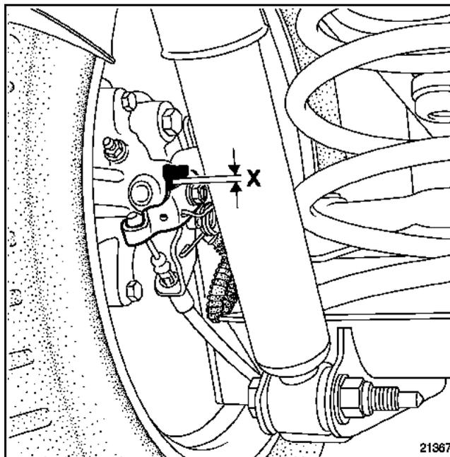
Mesurer les cotes X sur les étriers gauche et droit. La somme des cotes doit être comprise entre **0,1 et 0,5 millimètre**.
