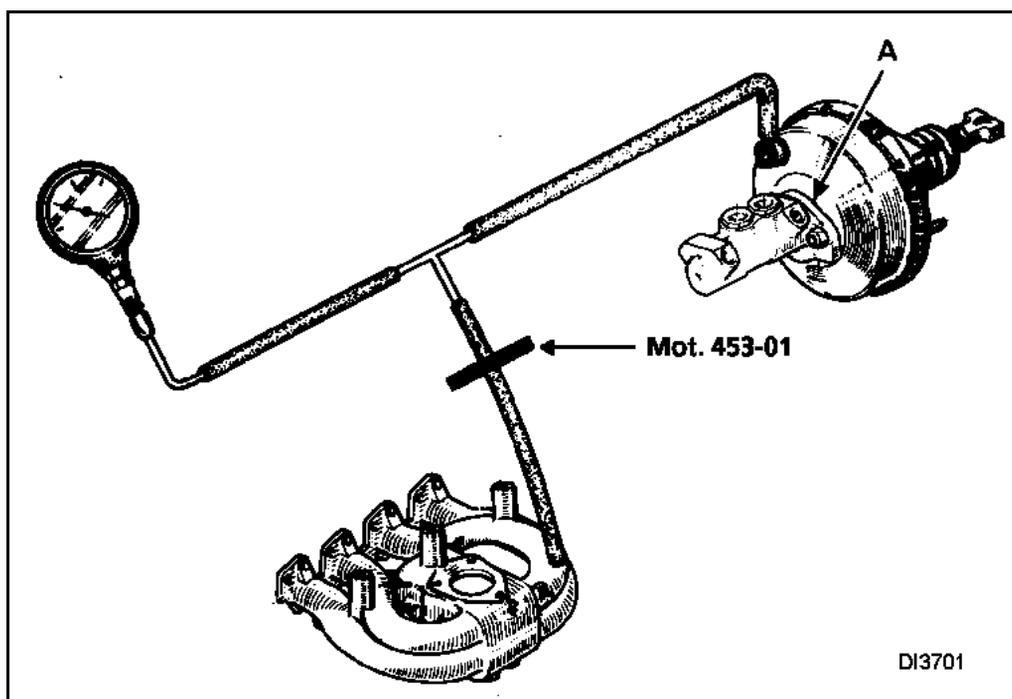
La vérification de l'étanchéité du servofrein doit se faire sur le véhicule, le circuit hydraulique étant en parfait état de fonctionnement.
