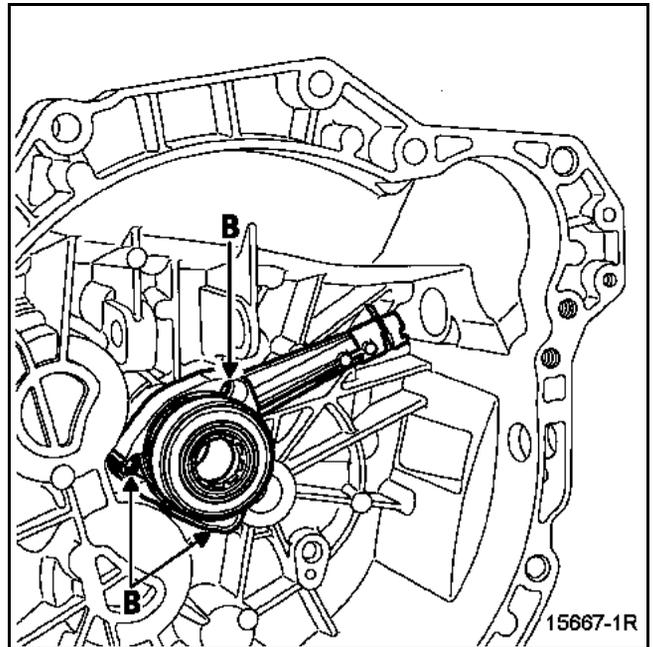
**ATTENTION** : ne jamais faire fonctionner le système lorsque le récepteur est déposé (même si celui-ci est relié avec la pédale d'embrayage), sous risque d'éjection du piston hydraulique et de la butée du récepteur.
