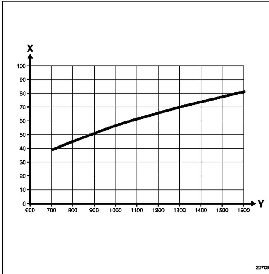
X = Pression de sortie **P2 (bars)** (pour une pression de **100 bars** à l'avant)
