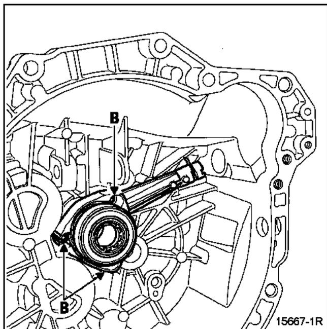
**IMPORTANT** : pour éviter d'endommager le récepteur, ne pas enduire l'arbre de sortie de boîte de vitesses avec de la graisse.
